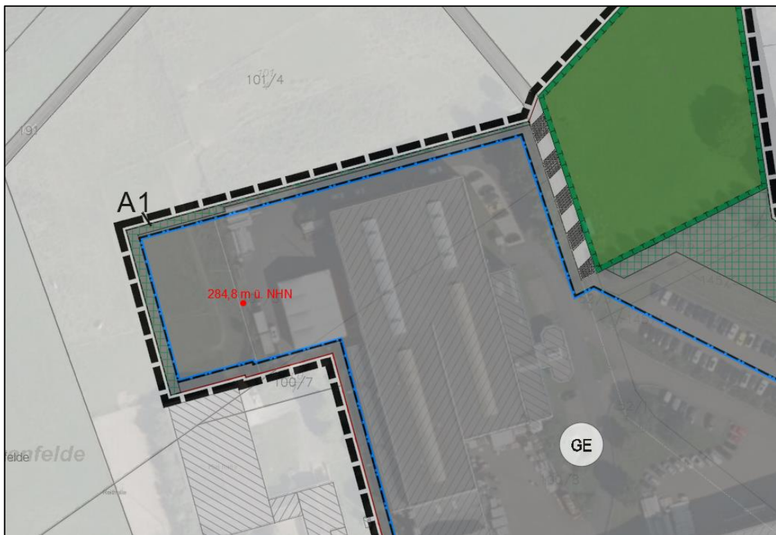
Abb. 7: Referenzpunkt für die Höhenfestsetzung d. Erdgeschossfußbodenhöhe
